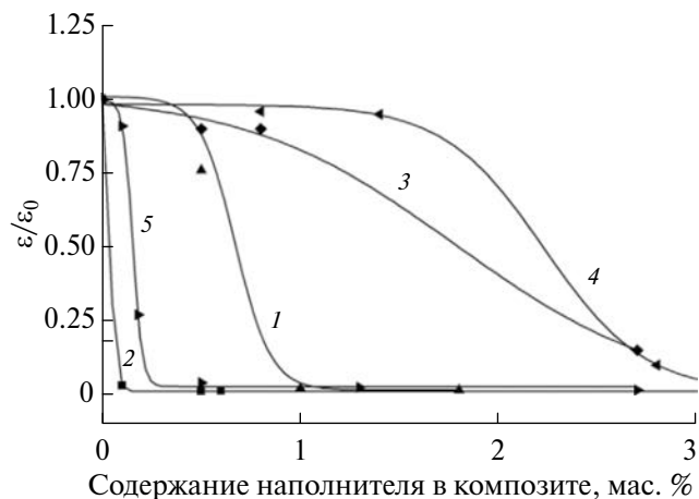
Рис. 8. Зависимость относительного удлинения при разрыве \varepsilon/\varepsilon_0 от содержания наполнителя. Матрица — изотактический ПП. Наполнитель — ГНП, обработанный ультразвуком (1), ГНП (2), фуллерен (3), НГ (4), МУНТ (5).
