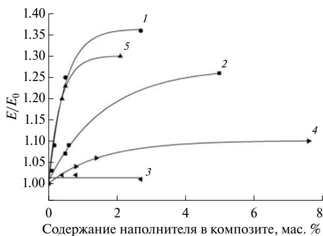
Рис. 7. Зависимость относительного модуля упругости композита E/E_0 от содержания наполнителя. Матрица – изотактический ПП. Наполнитель – ГНП, обработанные ультразвуком (1), ГНП (2), фуллерен (3), НГ (4), МУНТ (5).
