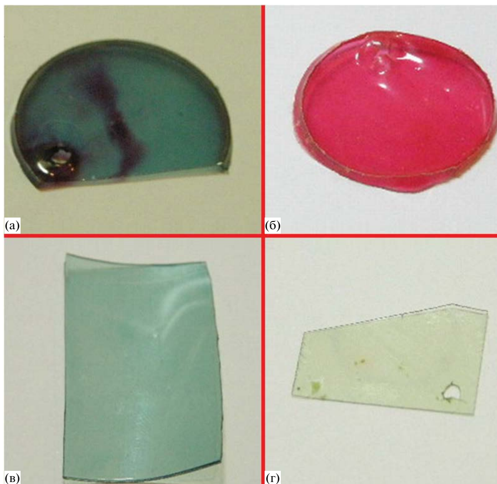
Рис. 8. Фотографии образцов ПВХ (а), Ф-42 (б), ПК (в) и ПЭ (г) после их импрегнации молекулами САО в среде сверхкритического \text{CO}_2 .
